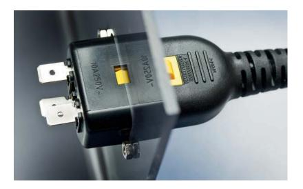
Die Verrastung wird durch Fingerdruck auf den Entriegelungshebel wieder freigegeben. Dieser ist dank seinem leuchtend hellen Gelb gut erkennbar und unterscheidet dieses System von herkömmlichen Netzsteckverbindungen. Die Auszugskraft beträgt mindestens 200 N.
